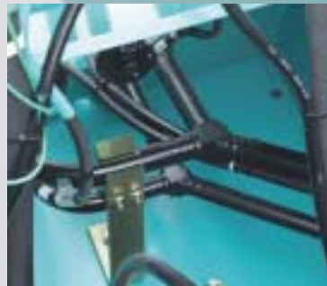
圧力損失を抑えるY形状の継手
