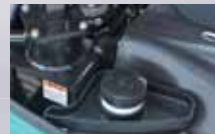
目視しやすい右ガード内に配置した大型バッテリー&燃料タンク。
