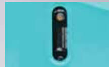
作動油レベル確認が一目でできるインジケータ小窓。
