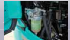
ボンネット内の最前面に設置したウォーターセパレータ。
