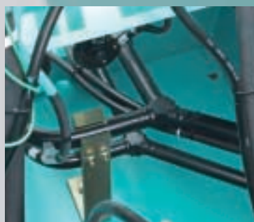
圧力損失を抑えるY字形の継手
