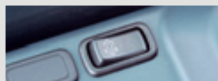
DPF再生スイッチ モニターにワーニングが点灯した場合、スイッチ操作によりフィルタの手動再生が行えます。
