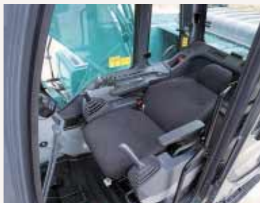
フラットにもできるリクライニングシート、質感アップしたキャブ内装部材およびデザイン
