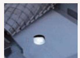
●キャブフロアマット下に設けたウォッシュ液タンク。
