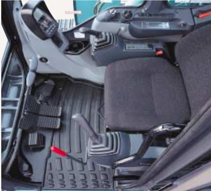
●前後にワイドな足元スペース。●横配置のオフセット操作ペダル。●大型走行ペダルを採用。
