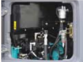
右サイド 油圧ポンプ/燃料フィルタ/ ウォーターセパレータ
