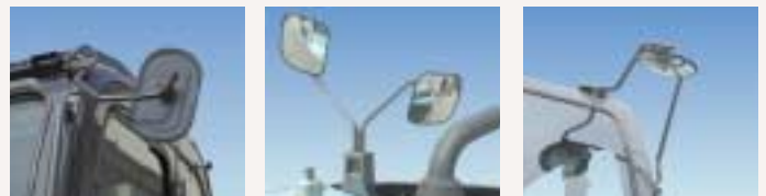
●左右バックミラー、右下部ミラー、リヤミラーにより安全視界を確保。
