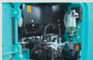
右後方ガード：油圧ポンプ/エンジン オイルフィルタ/ウォータセパレータ 一体燃料プレフィルタ/他
