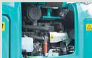
エンジンボンネット：エアクリーナ/ ラジエータサブタンク/他
