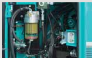
右サイドガード：コントロールバルブ/ マルチコントロール/燃料フィルタ/他
