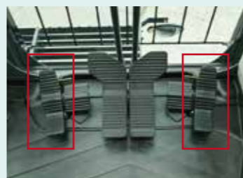
★ 回転F&G 操作ペダル LM MA SL HL 先端アタッチメントの回転操作や開閉操作がしやすい微操作性に優れた大型ペダルを採用。
