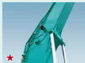
★ HD2 ポジションブーム LM SL HL 標準ブームに比べて大きな作業高さとしながら小さな作業半径を実現。
