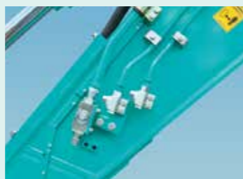
★ 回転F&G配管 LM SL HL 先端アタッチメントにフォークグリップまたはグラップルバケットの装着が可能。
