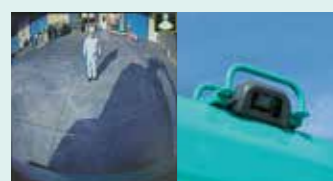
後方確認カメラ 機械後方の状況を、カラーマルチディスプレイ上で確認可能。
