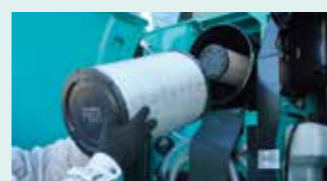
エアクリーナ (ダブルエレメント) 2重フィルタ構造かつ大容量タイプで粉じんのエンジン吸気混入を防止。
