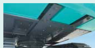
強化型上部本体アンダカバー アッパ底面に厚さ6mmの強化型カバーを装備し、内部機器を保護。
