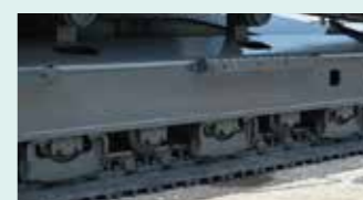
増設トラックガイド* 解体ガラを散乱する不整地走行時でもシューの脱輪を防止。 オプション
