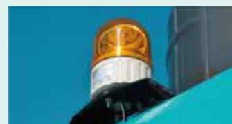
黄色回転警告灯 周辺作業者に稼働中であることを知らせ注意を喚起。 オプション
