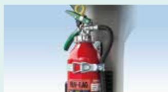
消火器 万が一の出火時にすぐに初期消火ができるようキャブ内に設置。 オプション
