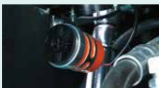
走行アラーム 機械の移動を周辺作業者に知らせ注意を喚起。 オプション
