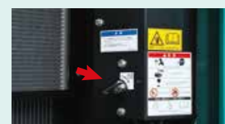
バッテリー遮断装置 長期にわたる休機時のバッテリー上がりスイッチ1つで防止。
