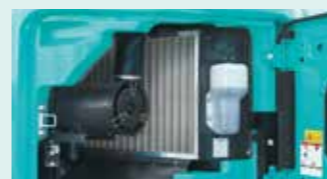
iNDr フィルタ* 粉じんの機内侵入を防止。ワンタッチで取り外せ、日常清掃も簡単。
