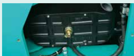
工具の要らないエンジンオイル クイックドレンコック
