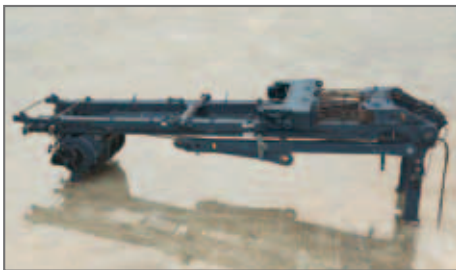
組立・分解効率を大きく高める、アタッチメントの一体輸送・一体組立
