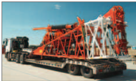
組立・分解効率を大きく高める、アタッチメントの一体輸送・一体組立
