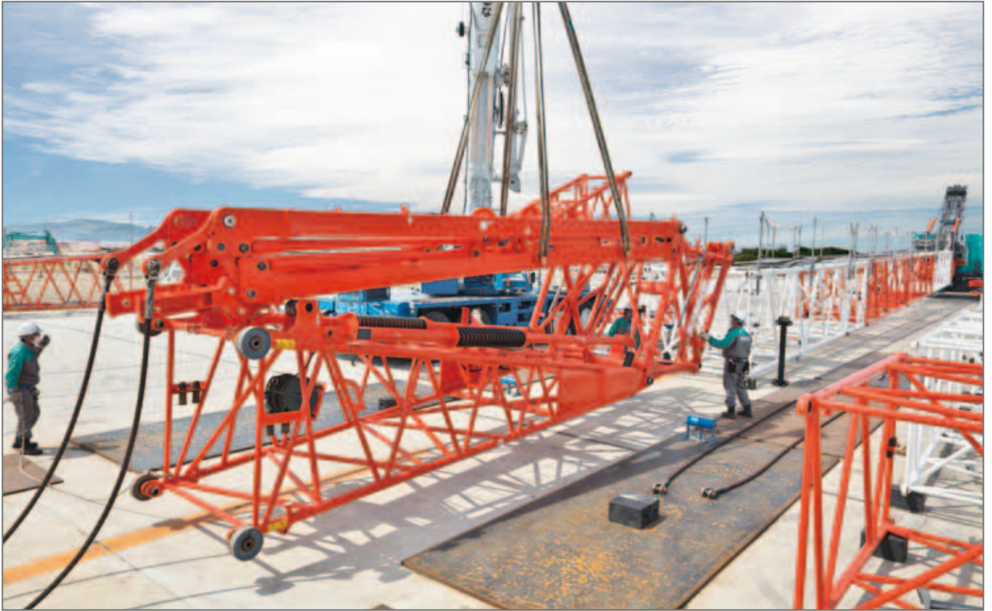
組立・分解効率を大きく高める、アタッチメントの一体輸送・一体組立
