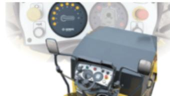
締固め度を簡単に把握！機械に搭載した加速度計により、転圧レベルをLEDランプによって10段階でリアルタイムに表示。
