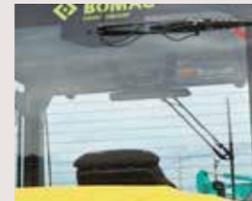
後方ガラスは、デフロッガー(電熱線)により雨天時の視界も良好です。
