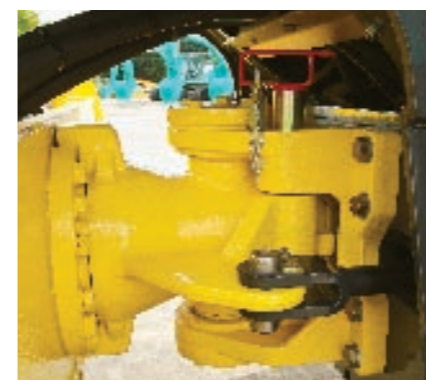
メンテナンスフリーのセンタージョイント 16 トン以下のモデルはグリス給脂が不要
