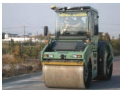
舗装用ヘビータンデムローラ (BW141AD-4AM)
