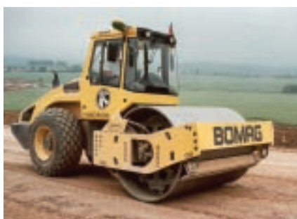
土工用シングルドラムローラ (BW213DH-4BVC)
