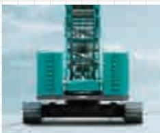
外側からのスリング大回し方式のため、玉かけ作業が簡単でつり荷が水平に安定します。また、芯合わせ突起部も積み込みしやすく進化した、薄型のカウンタウエイトです。
