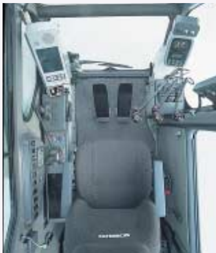
チルト機能付きクロスシート。FM/AMラジオ。サイドコンソールタイプのセミショートレバー。外気導入式エアコン。
