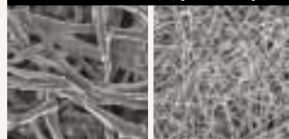
●従来フィルタ(ペーパー繊維) ●スーパーファインフィルタ(ガラス繊維)
