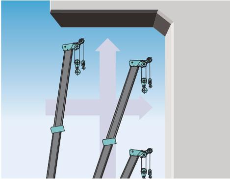
ブーム角度(上限/下限)、ブームトップ高さ、作業半径をあらかじめ設定することで、ブームの作動範囲を制限できます。設定位置に近づくと警報音が知らせ自動停止。ホイールクレーンで実績豊富な信頼高い機能です。接触を防止するだけでなく、繰り返し作業の効率アップにも使えます。
