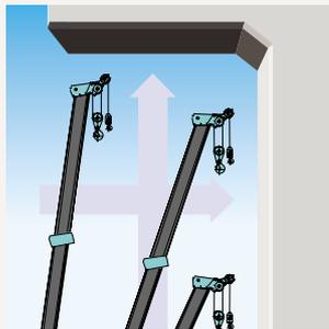
ブーム角度(上限/下限)、ブームトップ高さ、作業半径をあらかじめ設定することで、ブームの作動範囲を制限できます。設定位置に近づくとき警報音が知らせ自動停止。ホイールクレーンで実績豊富な信頼高い機能です。接触を防止するだけでなく、繰り返し作業の効率アップにも使えます。
