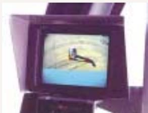
乱巻きなどのアクシデントの早期発見に役立つドラム監視カメラを主補ともに、さらに周辺作業者の安全確保に貢献する後方監視カメラを用意しています。見やすく操作しやすいモニタ画面ですばやく確認できます。
