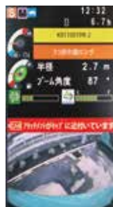
干渉の危険を知らせるマルチディスプレイのアラート表示
