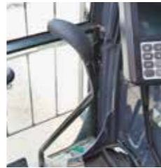
4つ折れ超ロング仕様機用操作レバーは足元に配置
