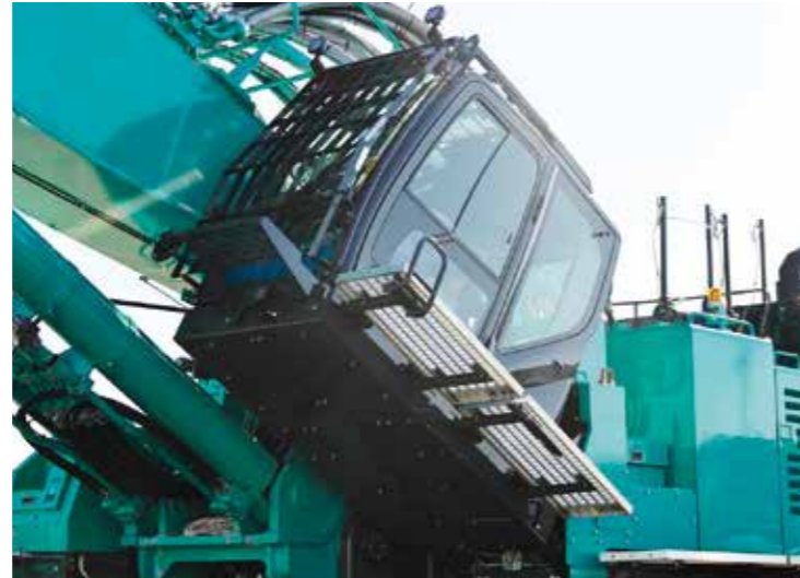
見上げる姿勢を長時間強いられる高所解体に適した30°チルトキャブ
