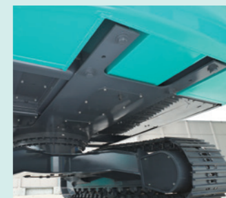
強化型上部本体アングダカバー 厚さ6mmの強化型カバーを装備し内部機器を保護。
