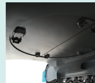
ロワアングダカバー ロワカーボディ下面に厚さ9mmの強化型カバーを装備。
