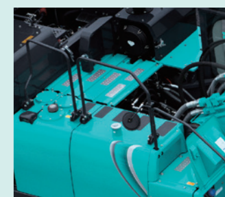
メンテナンススペース ボンネット内の点検などが楽な姿勢で行える本体上部空間。
