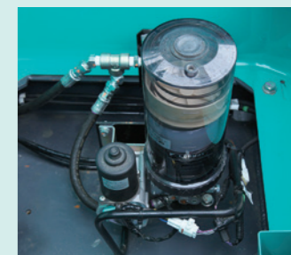
アタッチメント自動給脂装置 決められた時間ごとに自動的に給脂。始業時給脂の煩わしさをカット。
