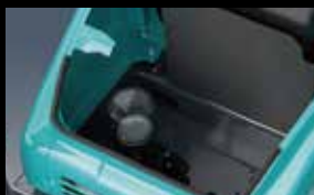
アタッチメント自動給脂装置 決められた時間ごとに自動的に給脂。始業時給脂の煩わしさをカット。
