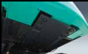
強化型上部本体アンダカバー 6mm厚の鋼板製カバーが本体内部機器を保護
