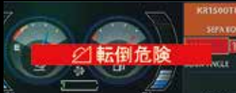
転倒危険警告表示
