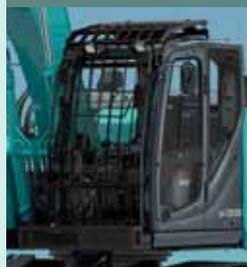
伐採材の接触や落下物・飛散物による前面ガラスの破損を防止。視界を遮らない放射状の縦格子タイプ。上ガードは清掃しやすいワンタッチ開閉式。
