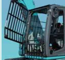
伐採材の接触や落下物・飛散物から前面ガラスをガードし破損を防止。視界を遮らない放射状の縦格子タイプで、上ガードはワンタッチ開閉式でガラス清掃も容易。
