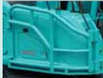
コントロールバルブなどの内部機器を伐採材などの接触から保護。メンテナンス性を損わない開閉式構造。
