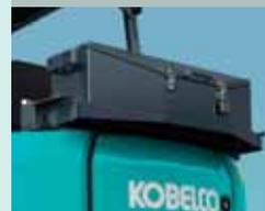
より大容量でアクセスしやすい形状へと変更した新しい大型工具箱を操縦席後方に設定。
