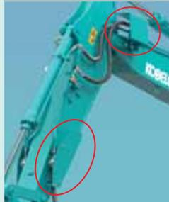
立木や伐採材にアームやブームが接触した際の配管損傷を防止。
