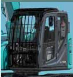
伐採材の接触や落下物・飛散物による前面ガラスの破損を防止。視界を遮らない放射状の縦格子タイプ。上ガードは清掃しやすいワンタッチ開閉式。
