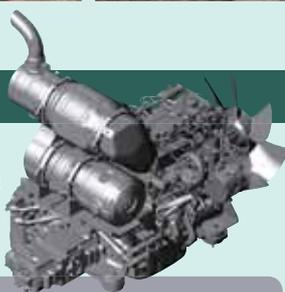
エンジン定格出力：**78.6kW/2,200min<sup>-1</sup>**
