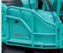
下からの枝の突き上げや、メンテナンスのしやすさに配慮した、新形状の大型パイプガードを用意。
