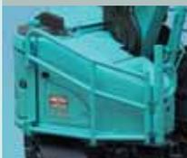
伐採材などの本体右サイド接触時に、内部のバッテリーや燃料タンクなどの損傷を防止。ボールタイプのガードも選択可能。
