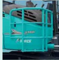
材が接触しやすい本体右サイドを保護し、右カバーおよび内部機器の破損を抑制。
