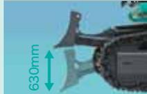
最低地上高を超える630mmの上昇量により走行時の切株回避が可能。
