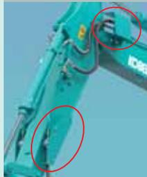
立木や伐採材への接触による配管損傷を防ぐガードの装備が可能。
