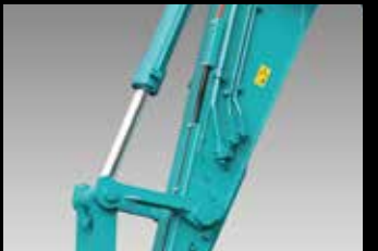
中通しマグネットケーブル アーム背面からイドラリンク間を通して接触による破断を防止。
