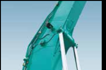
HD2 ポジションブーム 標準ブームに比べて大きな作業高さとな作業半径を実現。
