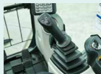
★ 3 ボタングリップ LM MA SL HL マグネット吸着・釈放またはキャブ干渉防止機能解除が操作グリップから手を放さずに可能。
