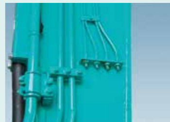
アタッチメント集中給脂 LM MA SL HL アタッチメント各ピン部の給脂箇所を集中配置して省力化。
