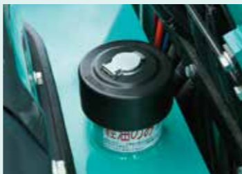
燃料タンク防じんキャップ LM MA SL HL 燃料給油口にはラバー被覆タイプでホコリが混入しにくいキャップを採用。
