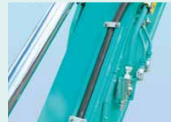
マグネットケーブルガード LM SL ケーブルの左右にガードレールを設け、引っ掛けによる断線を防止。
