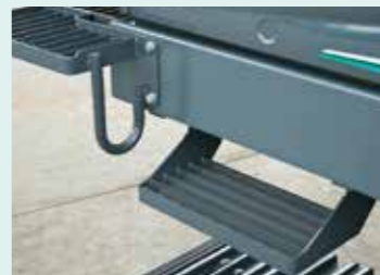
キャブ昇降ステップ・グリップ LM MA SL HL 最適な位置に配置しエレベータキャブへのスムーズな乗り降りを実現。
