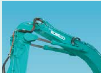
下付きアームシリンダ SL 力強いアーム持ち上げ力を発揮する下面付き2本シリンダ。
