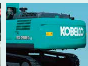
★ 専用カウンタウエイト LM MA SL HL 機体の動安定性を確保し作業効率を高める増量ウエイトまたはスペシャル増量ウエイトを搭載。
