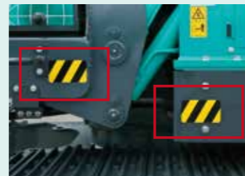
キャブ押しつぶし危険表示 LM MA SL HL エレベータキャブ降下時に架台との間に挟まれないよう注意を喚起。
