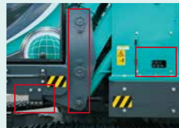
エレベータキャブ集中給脂 LM MA SL HL キャブ昇降機構部の給脂を地上の1カ所で行えるよう集中配置。
