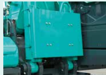
ブームフットガード LM MA SL HL スクラップの接触や飛散による配管やバルブ類の損傷を防ぐ大型ガードを装備。
