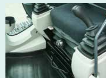
★ サスペンションシート LM MA SL HL 座り心地がよく長時間の作業でも疲れにくいサスペンションシートを標準装備。
