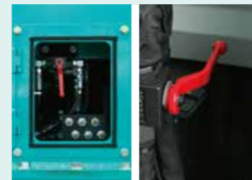
キャブ非常時降下装置 LM MA SL HL 万が一に備えキャブ内とキャブ架台後方にガード内の2カ所に操作レバーを設置。
