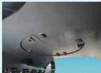
ロワアンダカバー LM MA SL HL ロワカーボディ下面に厚さ9mmの強化型カバーを装備。
