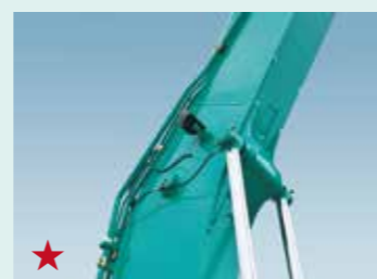
★ HD2 ポジションboom LM SL HL 標準boomに比べて大きな作業高さとし小さな作業半径を実現。
