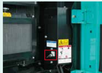
バッテリー遮断装置 LM MA SL HL 長期にわたる休機時のバッテリー上がりスイッチ1つで防止。
