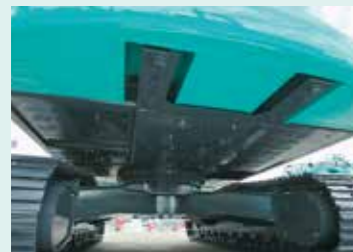
強化型上部本体アンダカバー LM MA SL HL 厚さ6mmの強化型カバーを装備し内部機器を保護。
