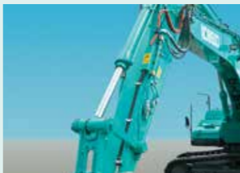
中通しマグネットケーブル LM SL アーム背面からアイドラリンク間を通して接触による破断を防止。
