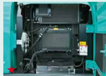
サブジェネータ LM MA SL 高出力パワーユニットの最適なヒートバランスを維持するために追加装備。
