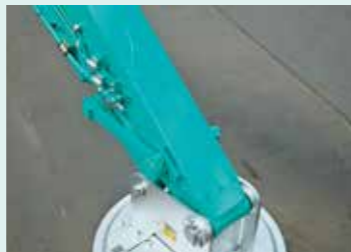
アームロックガード LM HL アーム先端付近の腹面に補強板を追加して強度をアップ。
