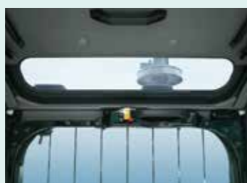
★ キャブ天井小窓 LM MA SL HL キャブの上方を確認したい時にシートに座ったまま目視が可能。
