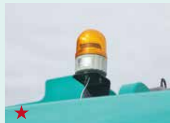
黄色回転警告灯 LM MA SL HL 周辺作業者に稼働中であることを知らせ注意を喚起。
