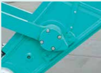
バケット角度センサカバー LM MA SL HL アイドラリンクに取り付けたバケット角度センサを保護。断線を防ぐケーブルガードも装備。
