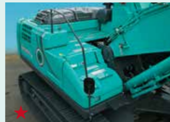
メンテナンススペース&ハンドレール LM MA SL HL エンジンボンネット内の点検などが安心して行えるアップ上部空間。
