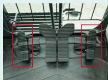
★ 回転 F&G 操作ペダル 先端アタッチメントの回転操作や開閉操作がしやすい微操作性に優れた大型ペダルを採用。
