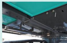
アッパ底部の鋼材補強
