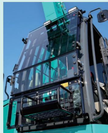
透明度が高くしかも傷つきにくい高強度ポリカーボネート製のフロントガードをオプション設定。格子ガードはもとより網ガードすらすり抜ける微細な解体片の飛散を確実にブロック。フロントガラスの破損を防ぎ、オペレータを危険から守ります。
