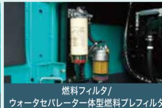
燃料フィルタ/ウォーターセパレーター型燃料プレフィルタ
