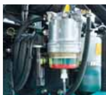
●容量アップした新型ウォーターセパレータ。
