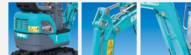
●強度に優れた鋼板製ガード、 耐候性の高いウレタン塗装
