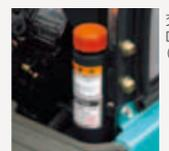
交換サイクル1000時間のロングライフ作動油(写真は注油口)
