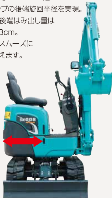
写真はクローラ幅拡張時
