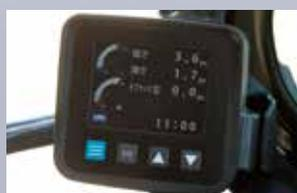
視認性に優れたカラー液晶表示のディスプレイをオプション設定。燃料計や水温計などマシン情報の表示だけでなく、メンテナンス情報や稼働管理情報の表示もできます。(ハイリークレーン仕様、高さ深さ制限装置設定時には標準設定)
