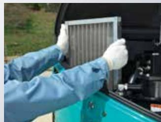
iNDrフィルタの日常点検はダストの溜まり具合の確認のみで、必要であればサッとエアブローするだけの簡単清掃。固定金具を持ち上げるだけのワンタッチ脱着構造なので取り外しも容易です。iNDrフィルタは、ラジエータやオイルクーラの目詰まりを防止するので、特殊工具を必要とした従来の冷却機器清掃に比べて、大幅に作業負荷を軽減しました。
