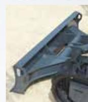
ドーザ作業に最適化されたブレード曲面が、土波を起こしながら確実に排土します。
