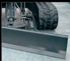
チルトアングルドーザ 対象機:SK45SR-7、SK55SR-7
