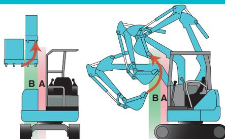
バケット爪先(またはアームトップピン)がB範囲に入るとアタッチメントが減速。A範囲の境界面に接すると、自動的にアタッチメントが接触を回避するよう動作します。
