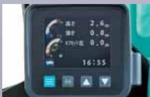
視認性に優れたカラー液晶表示の新型ディスプレイをオプション設定。燃料計や水温計などマシン情報の表示だけでなく、メンテナンス情報や稼働管理情報の表示もできます。(ハイリーチクレーン仕様、高さ深さ制限装置設定時には標準設定)
