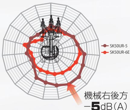
※従来機(SK50UR-5)比。無負荷ハイアイドル時、機側(右後方)1m、高さ1.5mにて実測。
