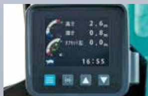
視認性に優れたカラー液晶表示のディスプレイをオプション設定。燃料計や水温計などマシン情報の表示だけでなく、メンテナンス情報や稼働管理情報の表示もできます。(ハイリーチクレーン仕様、高さ深さ制限装置設定時には標準設定)
