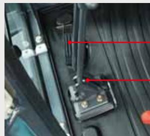
オフセット操作ペダルを横配置にして自然な操作感覚に。
