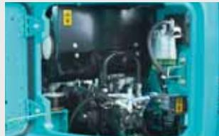
右後方ガード：油圧ポンプ／エンジンオイルフィルタ／ウォータセパレーター／一体燃料プレフィルタ／他
