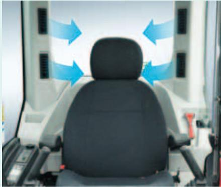
大容量エアコンを採用し、吹出口を運転席の右前方と左右後方ビラーに設置。冷風・温風を直接オペレータに当てることができるため、快適な環境を提供します。
