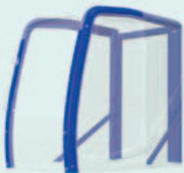
ROPS(Roll-Over Protective Structures)準拠のキャブは、ISO規格(ISO-12117-2:2008)をクリアし、マシン転倒時にオペレータにとって高い安全性を確保します。
