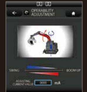
サービス工場にて、油圧流量の分配比率を利用方法に合わせて調節できます。
