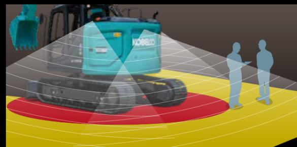
検知エリア内のヒトの姿を認識して、オペレータに警告を行うシステムです。ヒトらしき姿を認識する為、識別用のヘルメットや反射ベストなど特別な装備・備品は不要です。 ※検知エリアはイメージです。
