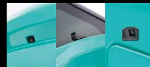
後方と側方に配置された広角カメラによる270度の映像が10インチカラーモニタに表示され、後方・左右の状況確認が可能となり、安全確認に貢献します。搭載されるカメラは周囲検知警報システムにも応用して、安全をサポートします。
