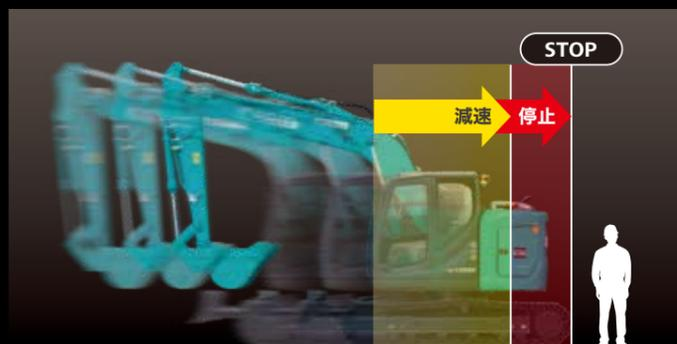
オペレータと周囲に注意喚起を行うとともに、減速制御を開始。停止エリア内まで接近すると停止制御を行います。オペレータが周囲作業者に気が付かず、走行を行った際の衝突事故発生の抑制に貢献します。
