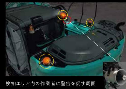
検知エリア内の作業者に警告を促す周囲検知警告灯、周囲検知アラームを設定。
