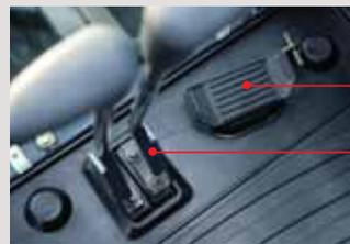
オフセット操作ペダルを横配置にして自然な操作感覚に。
