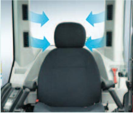
大容量エアコンを採用し、吹き出し口を運転席の右前方と左右後方ピラーに設置。冷風・温風を直接オペレータに当てることができるため、快適な環境を提供します。
