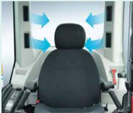
大容量エアコンを採用し、吹出口を運転席の右前方と左右後方ピラーに設置。冷風・温風を直接オペレータに当てる事ができるため、快適な環境を提供します。
