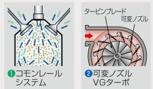
② 排気側のノズルの開度で吸入空気量を調整し、燃焼効率を最適化。低回転域ではノズルを絞りターボ回転速度を高めて空気量を増大。燃費低減にも寄与します。
