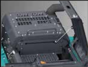
エンジンメンテナンス 主要箇所へのアクセスを 考慮した開口部。
