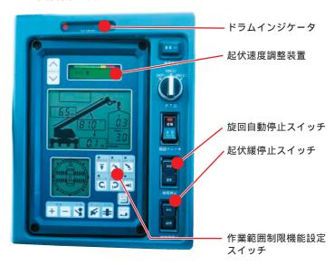
起伏角度、ブーム長、作業半径、アウトリガ張出幅等の 作業状況を1つの画面に液晶表示。安全な作業を見守ります。
