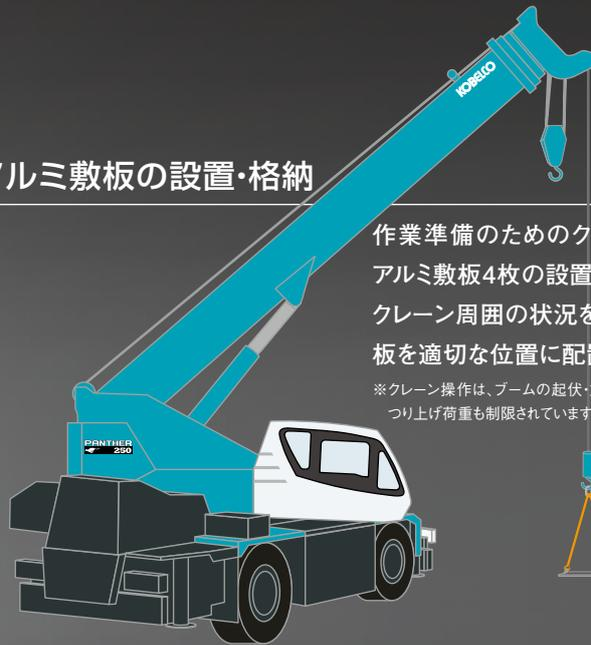
作業準備のためのクレーン操作モードでは、アルミ敷板4枚の設置・格納作業が可能。クレーン周囲の状況を確認しながら、アルミ敷板を適切な位置に配置出来ます。
