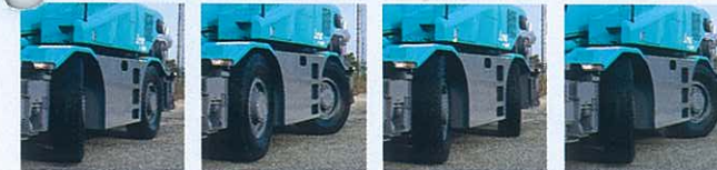
ノーマルステアリング リアステアリング クラブステアリング クランプステアリング
