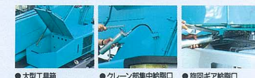
● 大型工具箱 ● クレーン部集中給油口 ● 旋回ギア給油口
