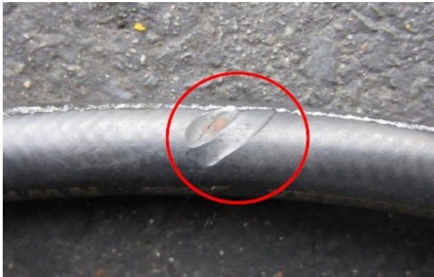
他のホースと干渉し摩耗したホース
